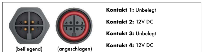
Abb.4: Kontaktbelegung des Motor-Steckverbinders
