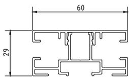
Zip Doppelführungsschiene Aufdopplung 10-50mm
